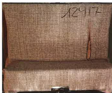
Il primo innesco sulla provetta
