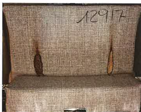
Il secondo innesco sulla provetta
