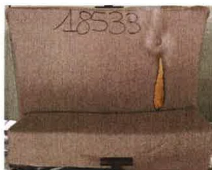
Il primo innesco sulla provetta campione 2
