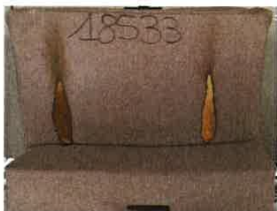
Il secondo innesco sulla provetta campione 2
