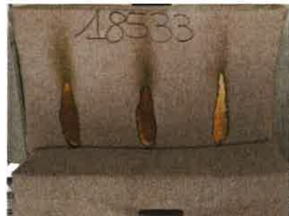
Il terzo innesco sulla provetta campione 2
