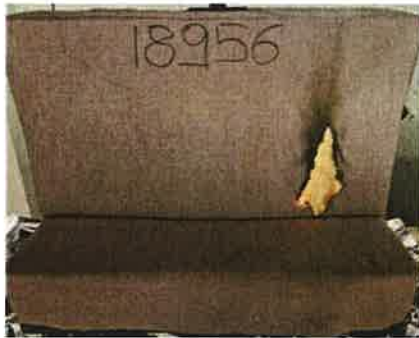
Il primo innesco sulla provetta campione 1
