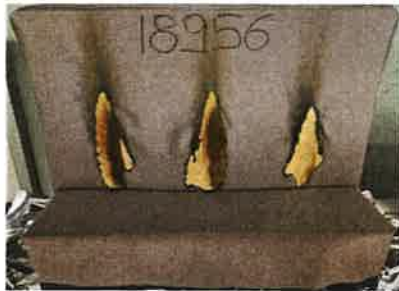
Il terzo innesco sulla provetta campione 1
